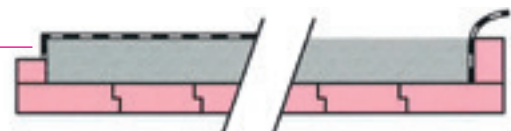
Coffrage de fondations avec étanchéification horizontale
