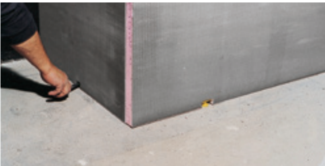
Pied réglable pratique en plastique dur. Facilement réglable en toute précision à la hauteur désirée avec une clé plate de 17 (jusqu'à environ 10 cm).
