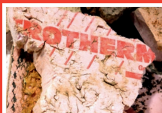
altes XPS aus Abbrüchen (roter Aufdruck)
