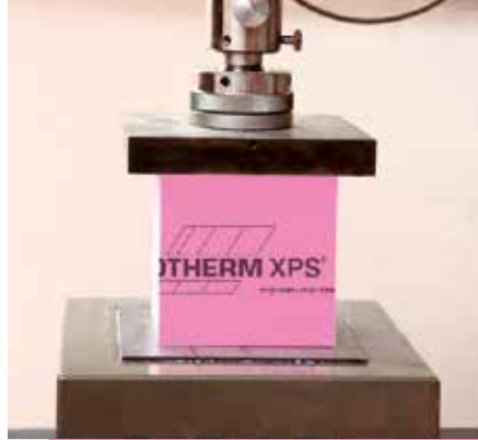
Langzeitmessung der Druckfestigkeit
